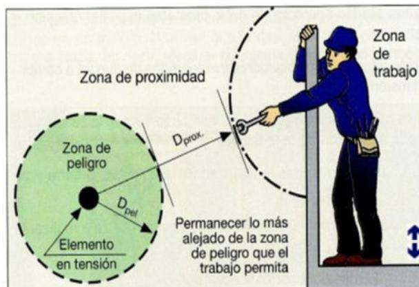
Se puede hacer uso de barreras físicas, que impidan a los trabajadores/as invadir la zona de peligro. Lo más adecuado sería colocar una barrera no conductora, si bien, en el caso de ser de material conductor ha de ponerse a tierra y mantenerse a una distancia del elemento en tensión previamente calculada.
