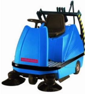
Maquinaria manual o automática, eléctricas o de gasoil cuya función principal es la de barrido y/o fregado y/o secado. Generalmente suelen ser barredoras y de forma independiente fregadoras-secadoras, existiendo también maquinas multifunción que abarcan todas las funciones.
